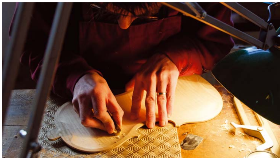
Premiers apprentissages pour les jeunes étudiants de l'École autour de la réalisation d'un violon, ici le travail du dos.
