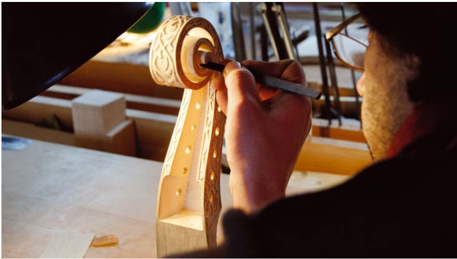
Un étudiant, expérimenté et intégré directement en 2 ème année, parachève avec finesse la volute d'une viole de gambes.
